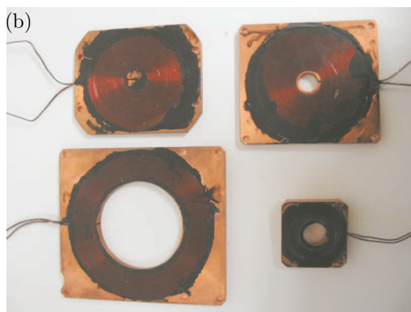
FIGURE 12 – (a). Support d'une bobine fabriqué à l'atelier de mécanique du département de physique de l'ENS. (b). Différents types de bobines : bobine de transport, bobine "poussante", bobine PMO et bobine de courbure du piège magnétique en configuration Ioffe-Pritchard.
